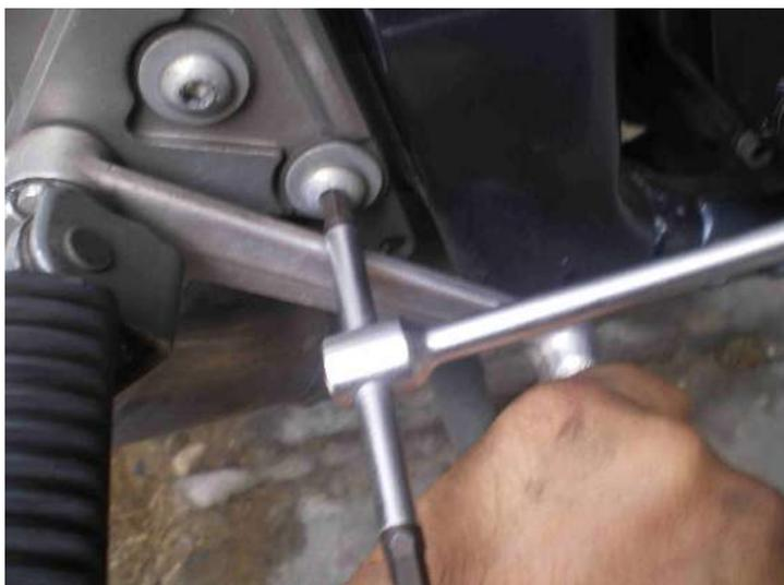
Per rimuovere una delle viti esercitate una pressione alla leva del freno per riuscire ad inserire la chiave.
