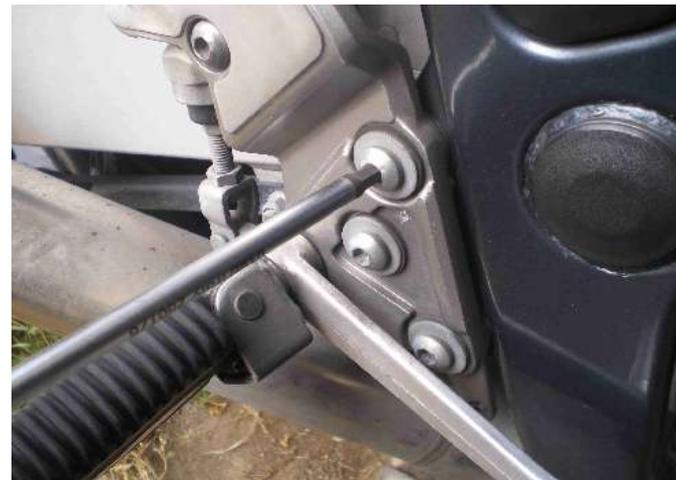
Con la chiave esagonale da 6 passiamo ora alla rimozione del supporto pedana / freno posteriore per accedere agevolmente ad uno dei dadi del biellismo (più avanti si vede).
