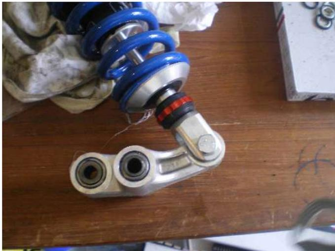
Controllando che sia nel verso giusto, mettete il nuovo mono, fissando il bullone senza stringerlo definitivamente (lo faremo poi una volta montato).
