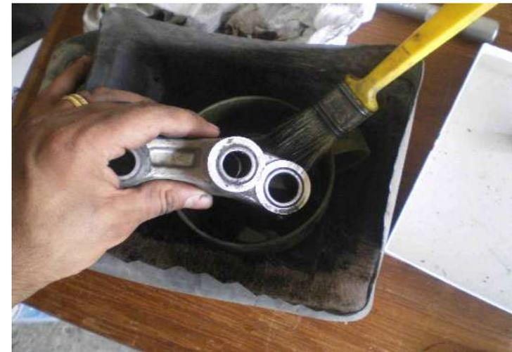
Pulite per bene tutto con il petrolio. Insistendo soprattutto sui rulli, provando più volte il loro scorrimento, soffiare via l'eccesso di petrolio e controllate nuovamente. Ripetete più volte l'operazione fino a che i rulli non scorrano bene.
