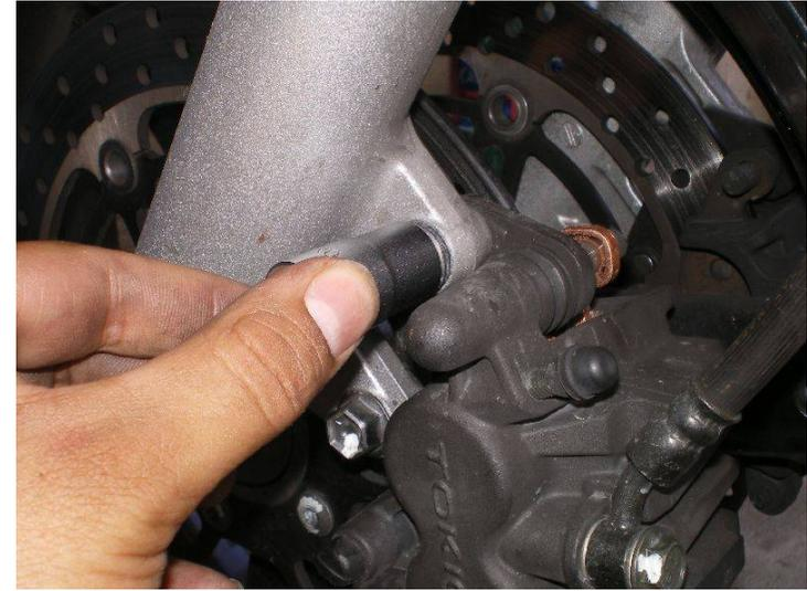
...avvitare i bulloni di fissaggio. La coppia di serraggio è di 39Nm. Praticamente equivalgono ad una stretta "appena forte"
